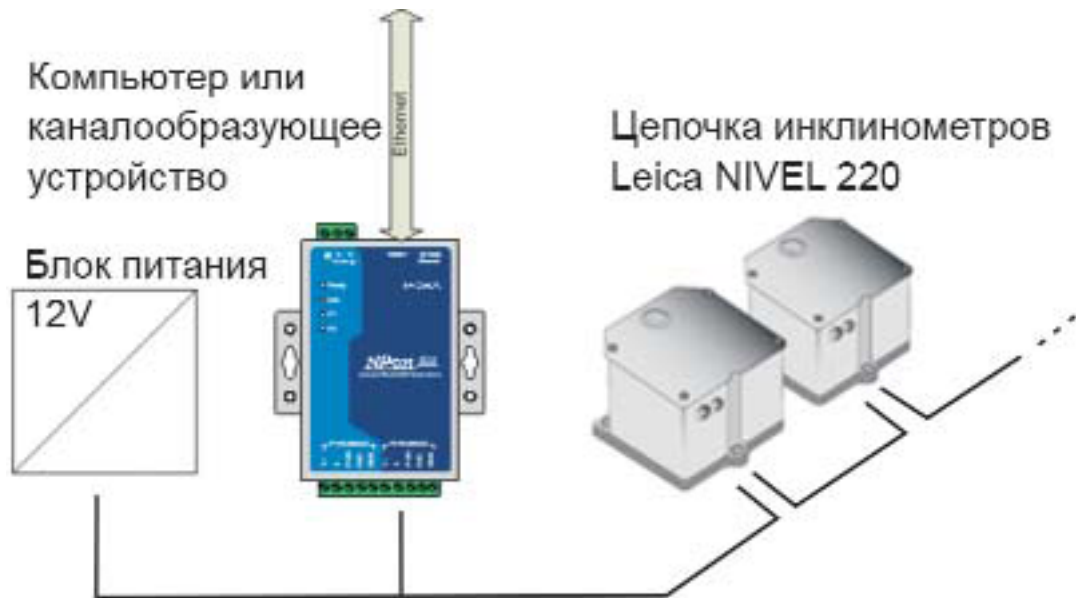
Рис.2 Схема измерительной сети для подключения N-го количества инклинометров
